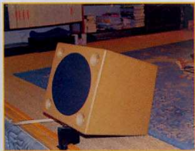
L'enceinte centrale est un modèle spécialement réalisé par Taylor Made System à partir d'un haut-parleur coaxial dirigé vers le mur blanc qui sert d'écran au vidéoprojecteur.
