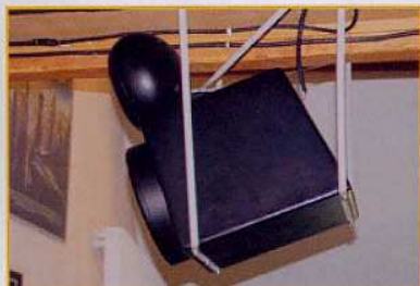
Les A2T B6030, en voie Surround latérales, sont dirigées vers le mur pour les rendre totalement indiscernables. Une seconde paire, placée derrière l'auditeur, complète la configuration 7.1.
